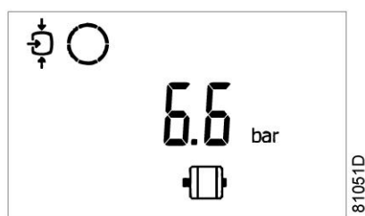
Ecranul principal cu indicator de oprire, suprasarcină motor
