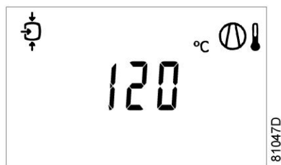
Ecranul de oprire, temperatura la ieșirea elementului
