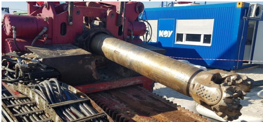
Exemplu sapa de foraj 12 ½ frezata tip tricon
