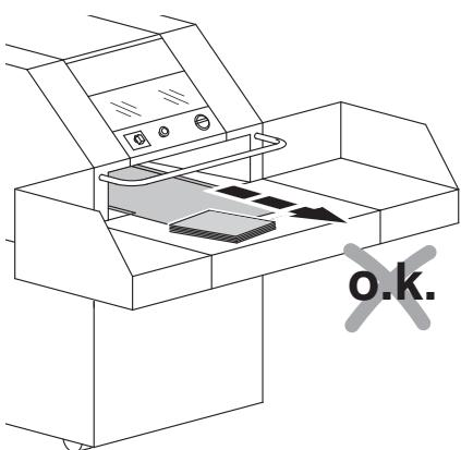
**DE Falsche Förderrichtung → Drehfeld von einer Elektrofachkraft ändern lassen.**
