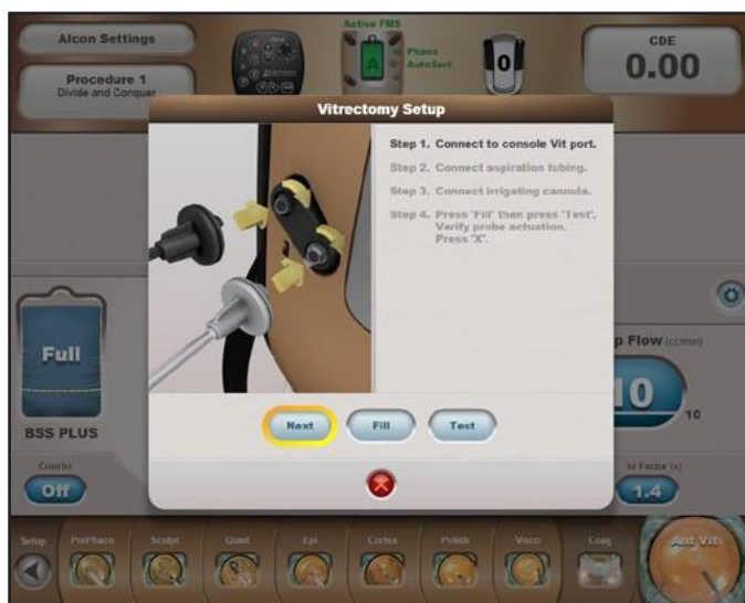
Figura 3-8 Caseta de dialog Anterior Vitrectomy Setup (Configurare Vitrectomie anterioară) După încheierea unei etape Vitrectomy Setup (Configurare vitrectomie), apăsarea butonului Next (Următorul) va afișa caseta de dialog pentru următoarea etapă de configurare. În etapa 6, butonul Fill (Umplere) permite utilizatorului să programeze sonda și să umple un vas de test pentru testarea corespunzătoare a sondei. Apăsarea butonului Test (Testare) va iniția o secvență automată de test care verifică siguranța conexiunilor pneumatice, apoi aplică o amorsare pneumatică la o viteză redusă de tăiere pentru verificarea vizuală a amorsării sondei.
