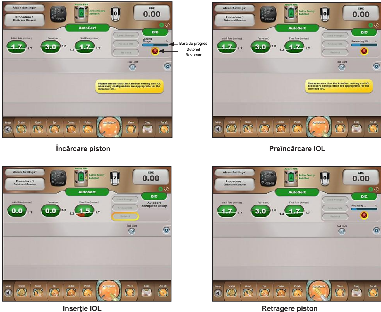
Figura 2-91 Injector IOL Intrepid™ AutoSert™ Trebuie să urmați o procedură scurtă înainte de a utiliza funcția injectorului AutoSert™ . În imaginea din stânga sus, pistonul este încărcat prin apăsarea butonului Load Plunger (Încărcare piston) . În imaginea din dreapta sus, este apăsat butonul Preload IOL (Preîncărcare IOL) după amplasarea cristalinului în poziția corectă pe vârful pistonului. În imaginea din stânga-jos se introduce cristalinul după apăsarea pedalei în poziția 2. După inserție, pedala este eliberată și butonul Retract (Retragere) este apăsat pentru a retrage pistonul înapoi în injectorul IOL.
