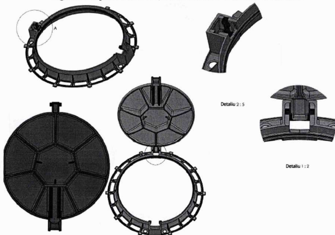
Figura 3. Capac fontă D400, rotund. Detalii
